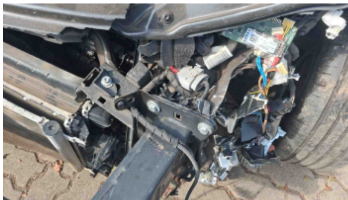
Foto Estrutura Longarina Esquerda
