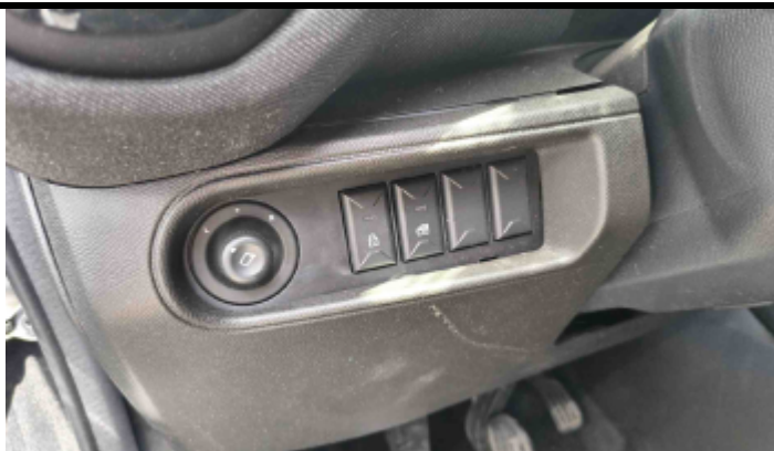
Foto Travas Elétricas
