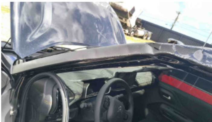
Foto Estrutura Coluna Dianteira Esquerda
