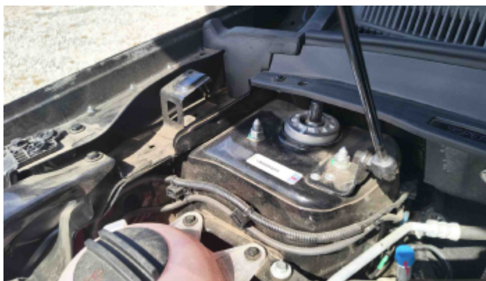
Foto Estrutura Torre do Amortecedor Direito
