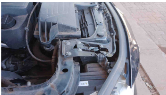
Foto Avaria Painel/Saia Dianteiro
