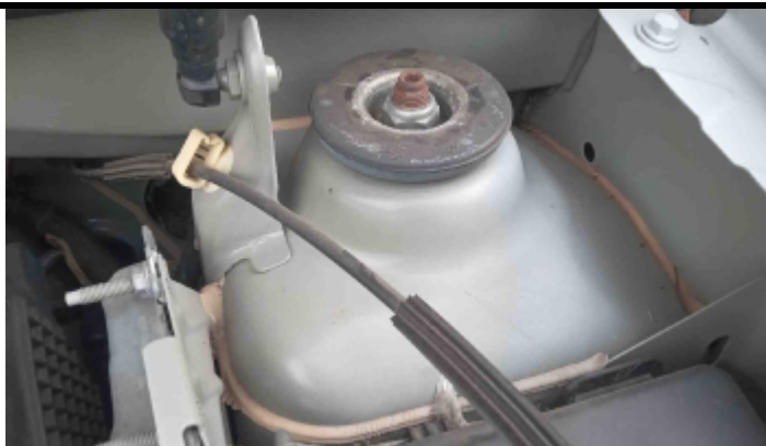
Foto Estrutura Torre do Amortecedor Esquerdo
