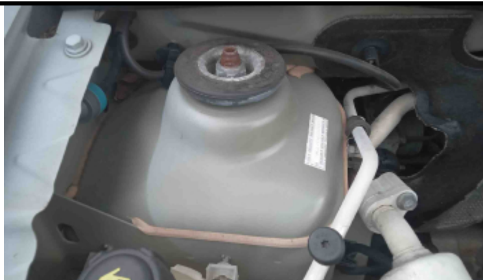
Foto Estrutura Torre do Amortecedor Direito
