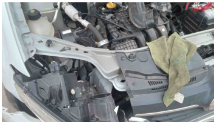
Foto Avaria Painel/Saia Dianteiro
