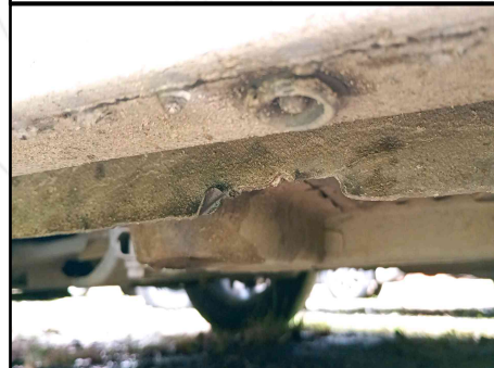
CAIXA DE AR/ SOLEIRA ESQUERDA
