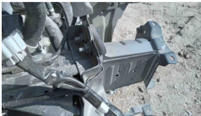
Foto Estrutura Longarina Direita
