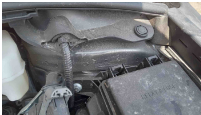
Foto Estrutura Torre do Amortecedor Esquerdo
