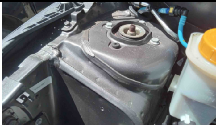
Foto Estrutura Torre do Amortecedor Direito
