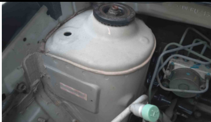
Foto Estrutura Torre do Amortecedor Direito
