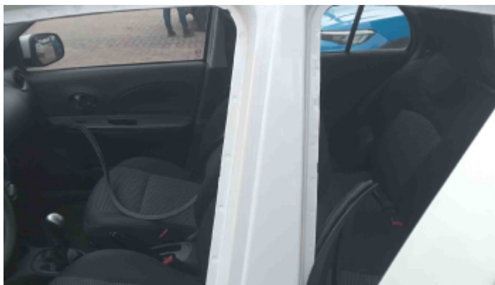
Foto Estrutura Coluna Central Esquerda
