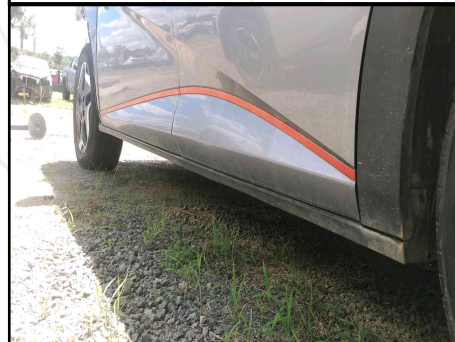
CAIXA DE AR/ SOLEIRA ESQUERDA
