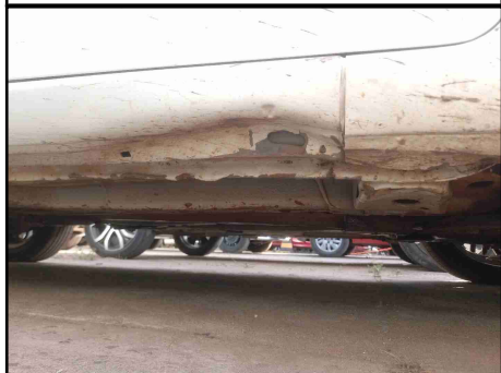
CAIXAS DE AR - SOLEIRA DIREITA
