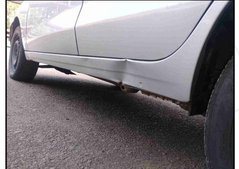
CAIXAS DE AR - SOLEIRA ESQUERDA
