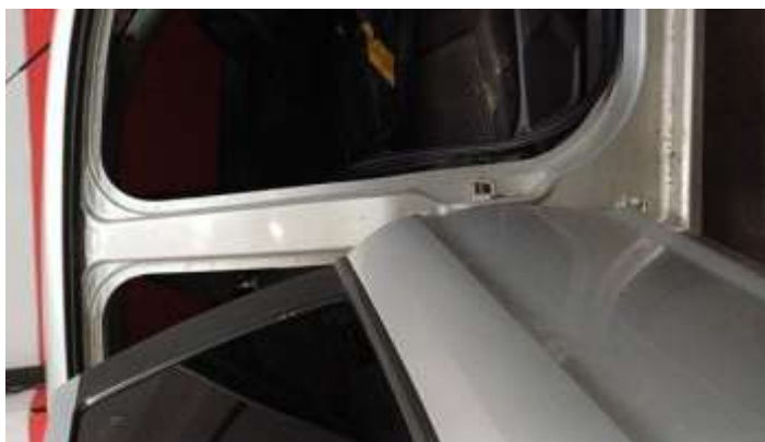
Estrutura Coluna Central Direita
