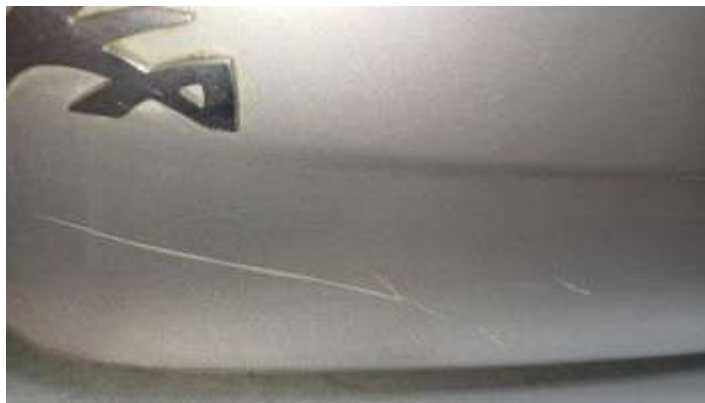
Avaria Tampa do Porta Malas
