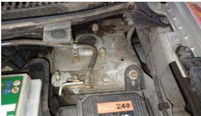
Estrutura Torre do Amortecedor Esquerdo
