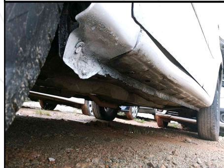
CAIXA DE AR/ SOLEIRA ESQUERDA
