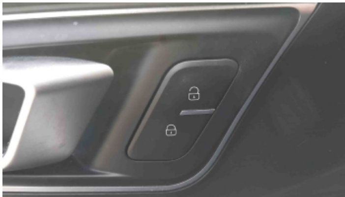
Foto Travas Elétricas
