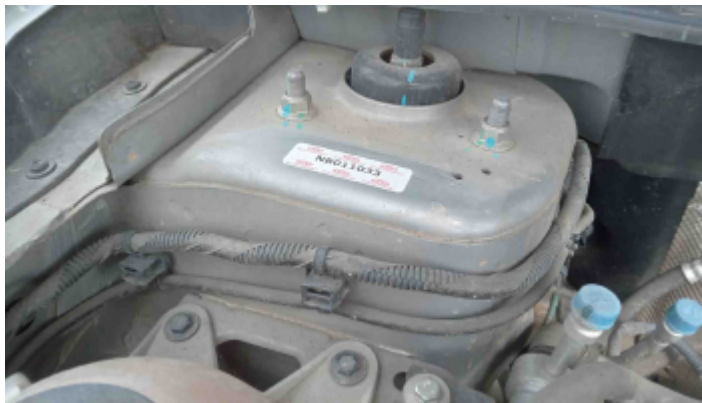
Foto Estrutura Torre do Amortecedor Direito
