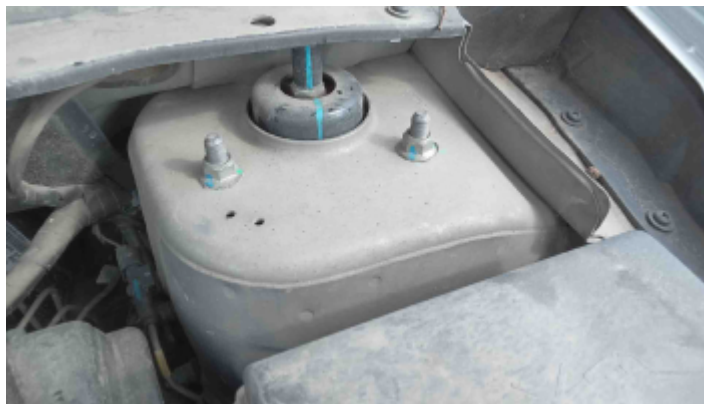
Foto Estrutura Torre do Amortecedor Esquerdo
