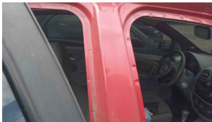
Foto Estrutura Coluna Central Direita
