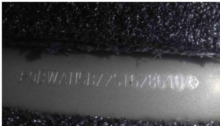
Foto da gravação do chassi : 9BWAH5BZ2ST628610
