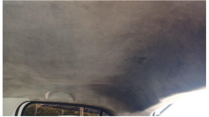
AVARIA REVESTIMENTO DO TETO
