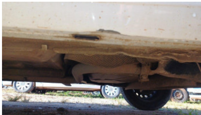
AVARIA CAIXA DE AR ESQUERDA
