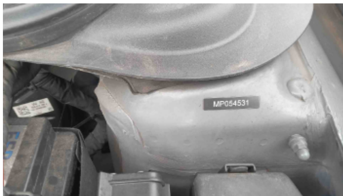
Foto Estrutura Torre do Amortecedor Esquerdo
