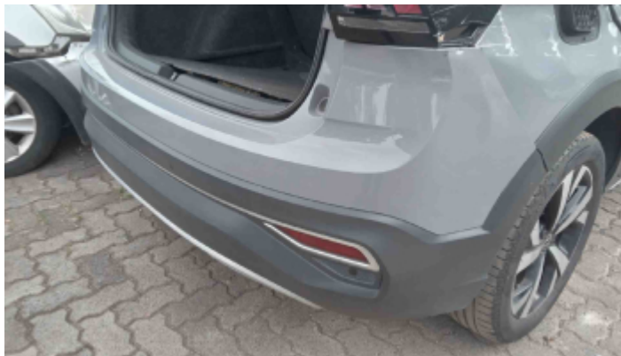
Foto Avaria Pára-Choque Traseiro
