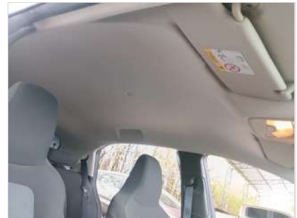
REVESTIMENTO DO TETO
