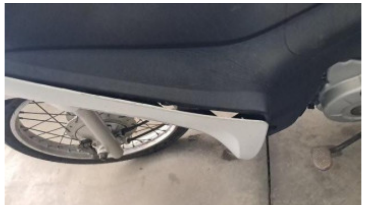
AVARIA CARENAGEM ESQUERDA
