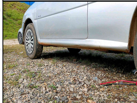
CAIXA DE AR/ SOLEIRA ESQUERDA
