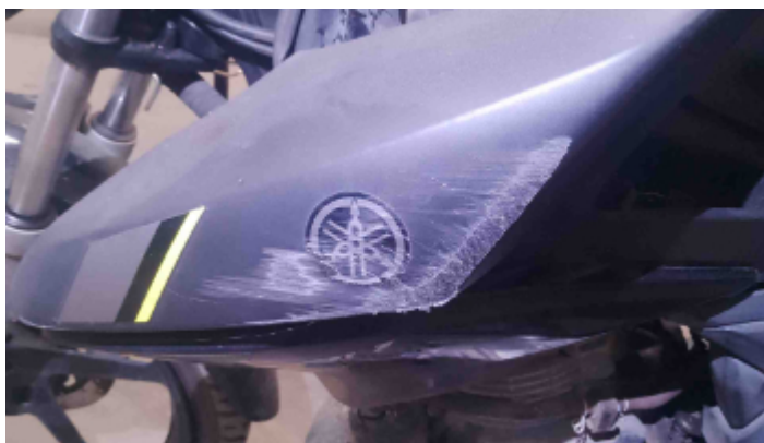
Foto Avaria Carenagem Esquerda
