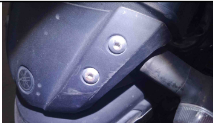
Foto Avaria Carenagem Frontal
