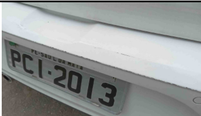
Foto Avaria Pára-Choque Traseiro
