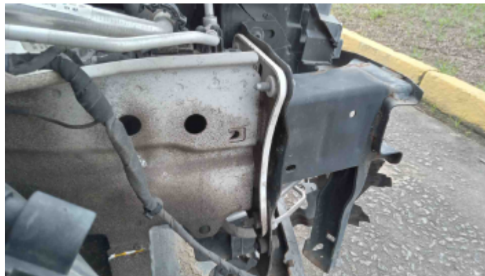
Foto Estrutura Longarina Direita
