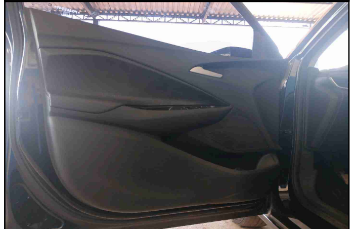
REVESTIMENTO INTERNO LATERAIS
