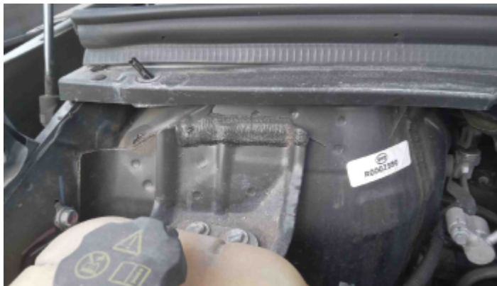
Foto Estrutura Torre do Amortecedor Direito
