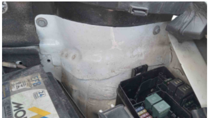
Foto Estrutura Torre do Amortecedor Esquerdo
