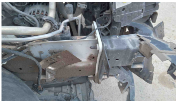
Foto Estrutura Longarina Direita
