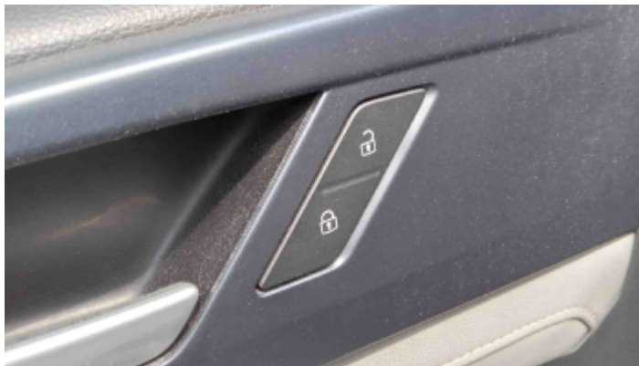
Foto Travas Elétricas
