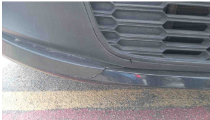
Foto Avaria Painel/Saia Dianteiro
