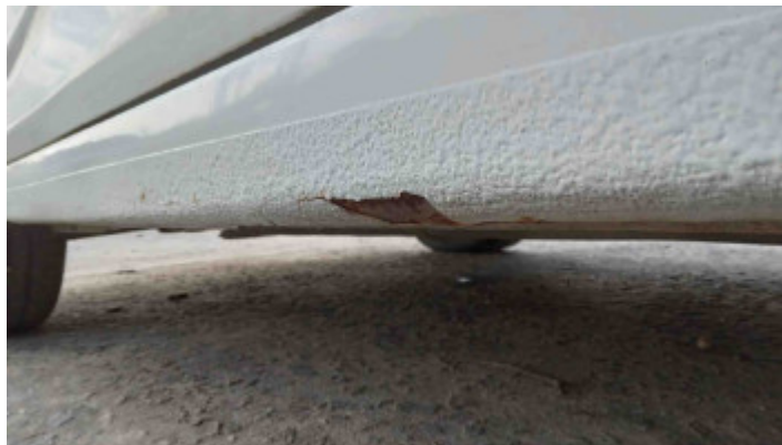
Foto Avaria Caixa de Ar (lado esquerdo)
