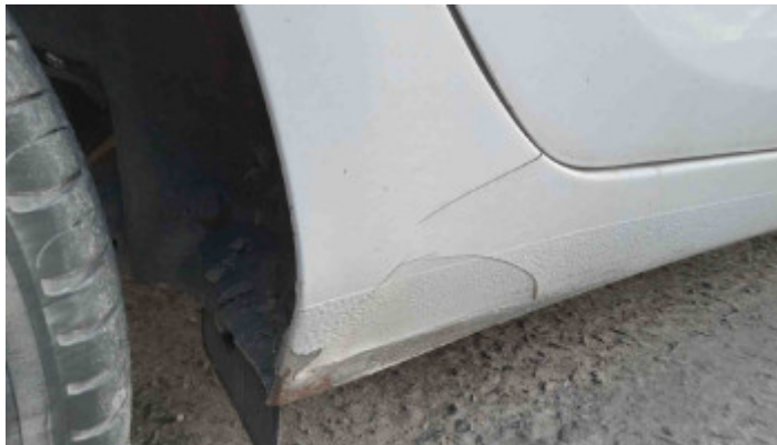
Foto Avaria Caixa de Ar (lado direito)
