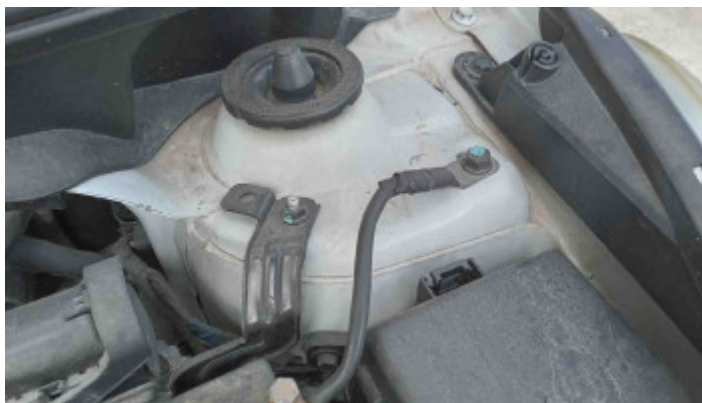
Foto Estrutura Torre do Amortecedor Esquerdo
