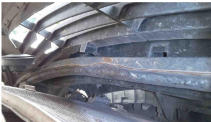
Foto Avaria Painel Dianteiro
