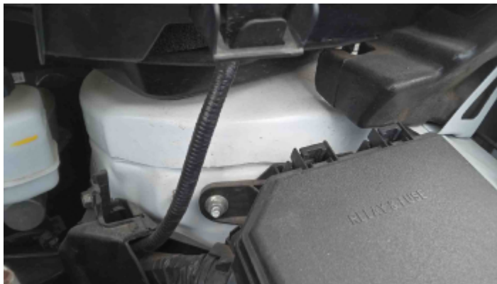
Foto Estrutura Torre do Amortecedor Esquerdo
