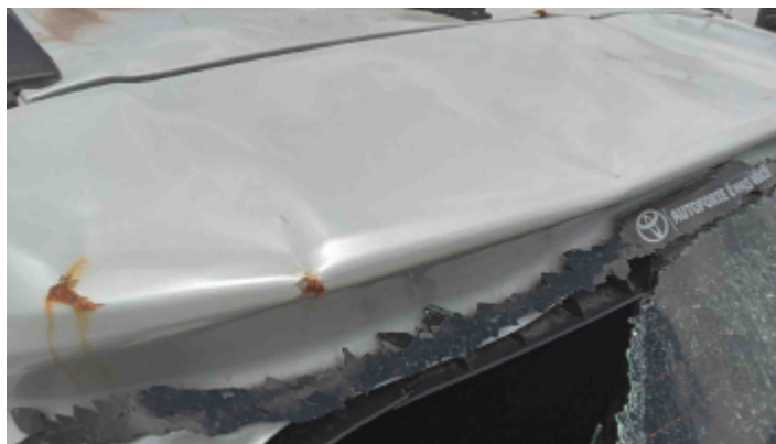
Foto Avaria Tampa do Porta Malas
