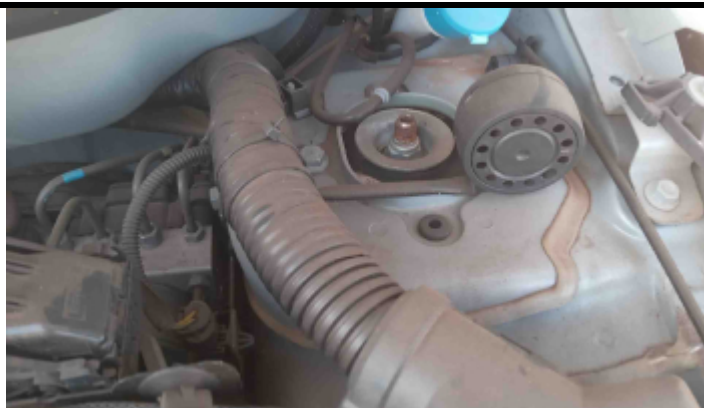
Foto Estrutura Torre do Amortecedor Esquerdo
