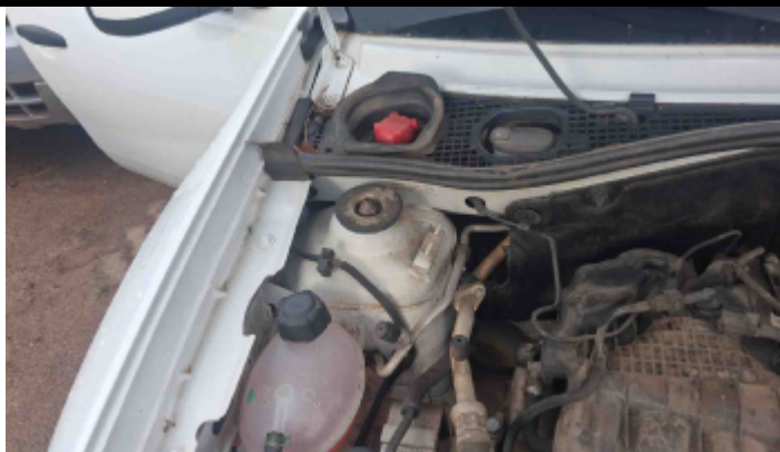
Foto Estrutura Torre do Amortecedor Direito
