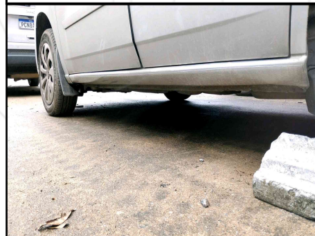
CAIXA DE AR/ SOLEIRA ESQUERDA
