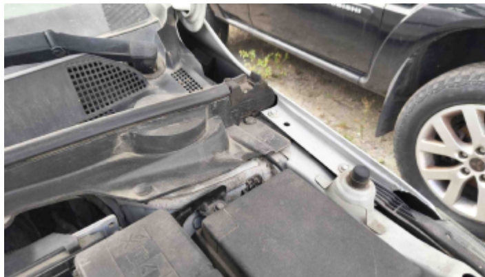
Foto Estrutura Torre do Amortecedor Esquerdo
