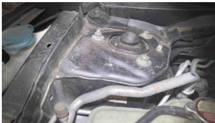
Foto Estrutura Torre do Amortecedor Direito
