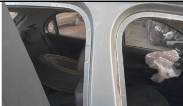
Foto Estrutura Coluna Central Direita
