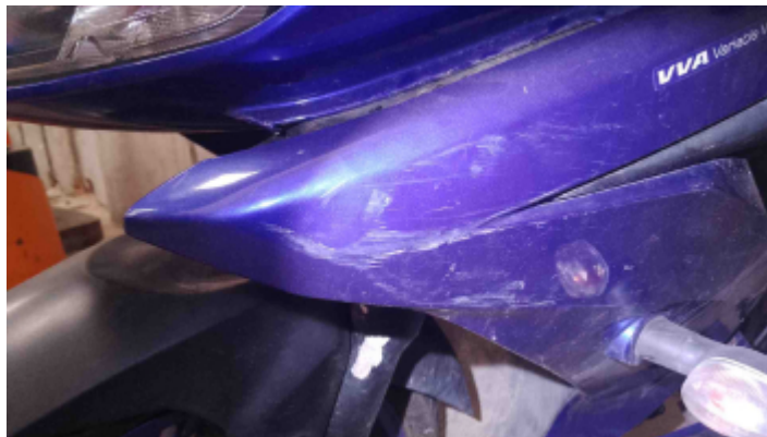
Foto Avaria Carenagem Esquerda
