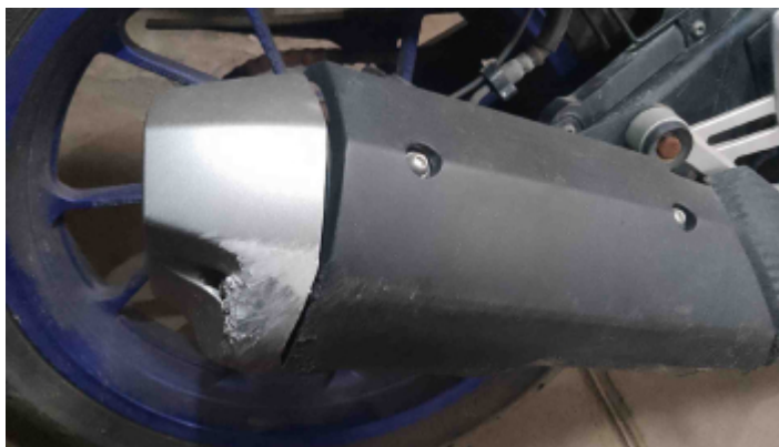
Foto Avaria Escapamento
