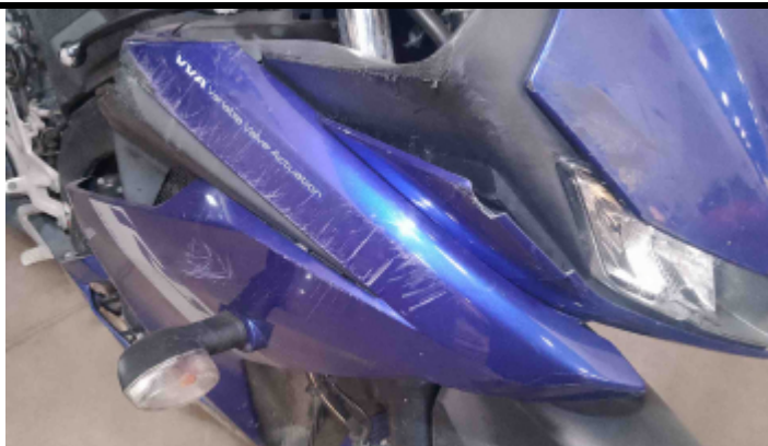
Foto Avaria Carenagem Direita
