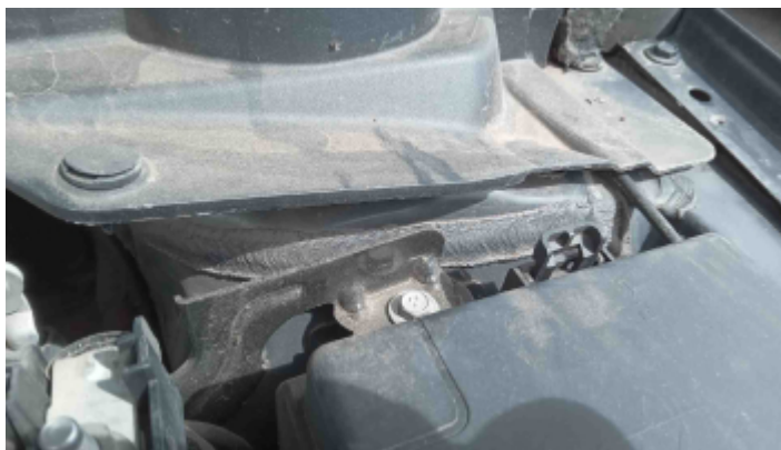
Foto Estrutura Torre do Amortecedor Esquerdo
