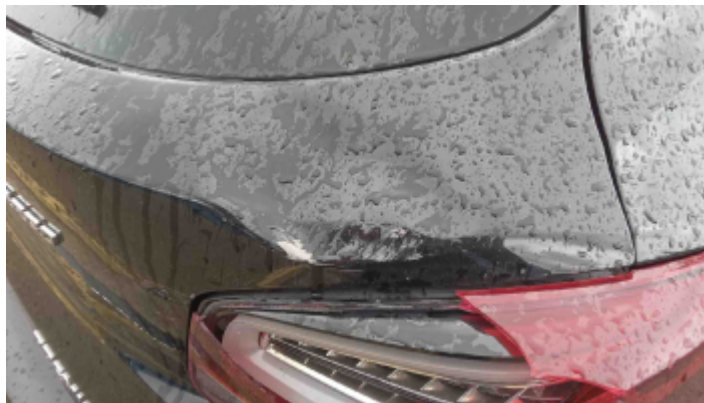
Foto Avaria Tampa do Porta Malas
