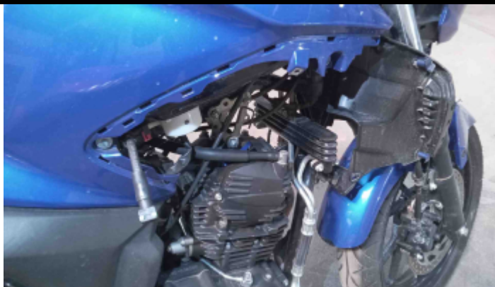
Foto Avaria Carenagem Direita
