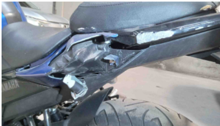
Foto Avaria Carenagem Esquerda
