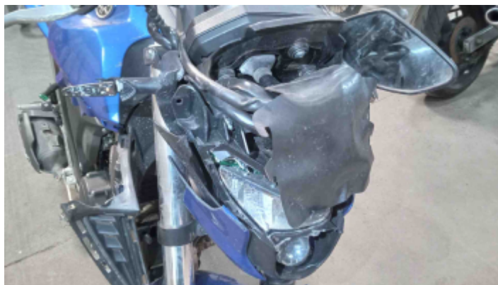
Foto Avaria Carenagem Frontal
