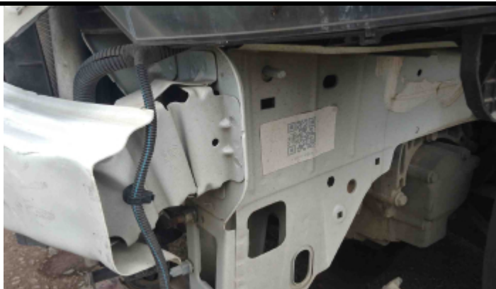
Foto Estrutura Longarina Esquerda
