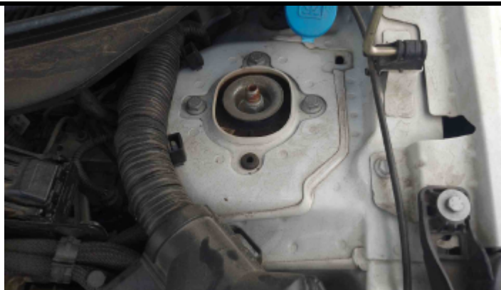
Foto Estrutura Torre do Amortecedor Esquerdo
