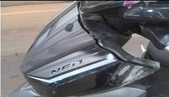
Foto Avaria Carenagem Frontal
