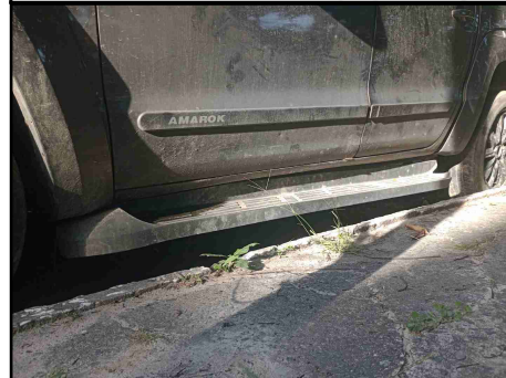
CAIXAS DE AR - SOLEIRA ESQUERDA
