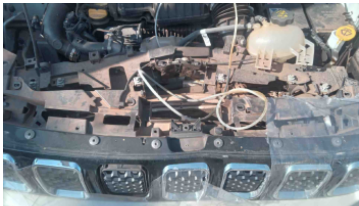
Foto Avaria Painel/Saia Dianteiro
