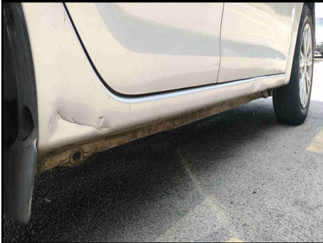
CAIXAS DE AR - SOLEIRA DIREITA
