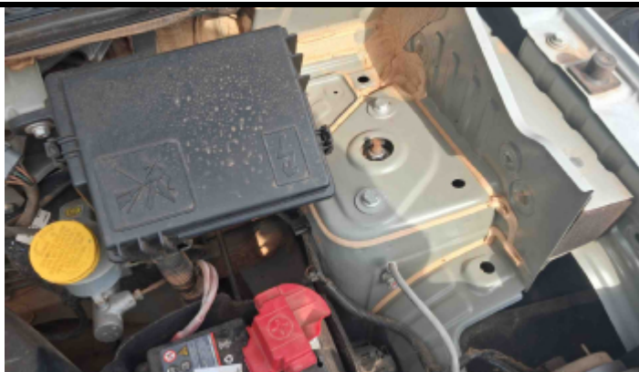
Foto Estrutura Torre do Amortecedor Esquerdo
