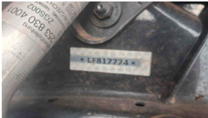
Foto da etiqueta ETA (compartimento do motor)
