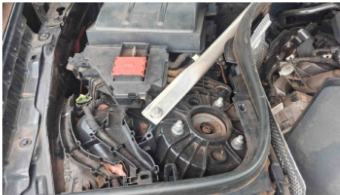
Foto Estrutura Torre do Amortecedor Direito
