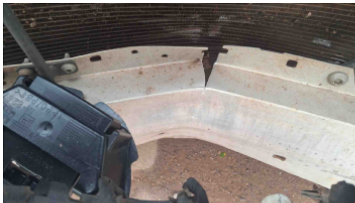
Foto Avaria Painel/Saia Dianteiro
