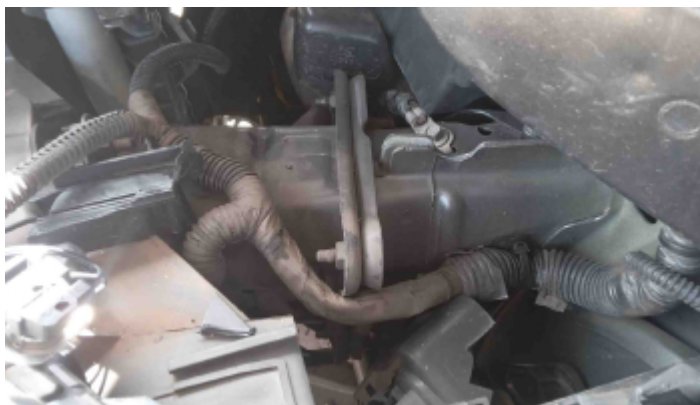
Foto Estrutura Longarina Esquerda
