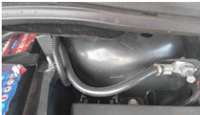
Foto Estrutura Torre do Amortecedor Esquerdo
