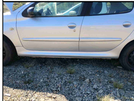
CAIXA DE AR/ SOLEIRA ESQUERDA
