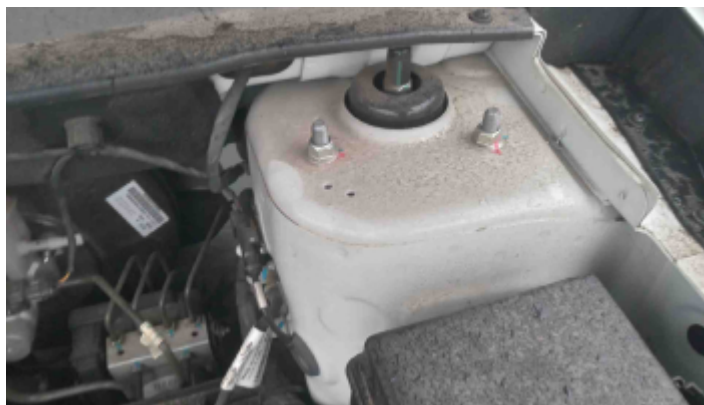
Foto Estrutura Torre do Amortecedor Esquerdo
