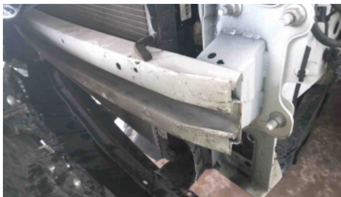
Foto Avaria Painel/Saia Dianteiro
