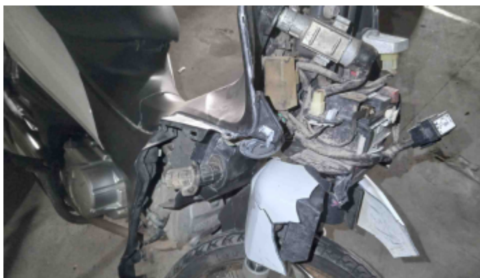
Foto Avaria Carenagem Esquerda
