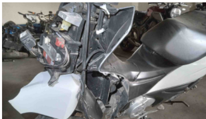
Foto Avaria Carenagem Direita
