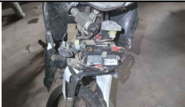
Foto Avaria Carenagem Frontal
